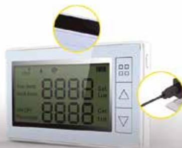
Carga mediante panel solar incorporado o Micro USB, con batería interna de litio
