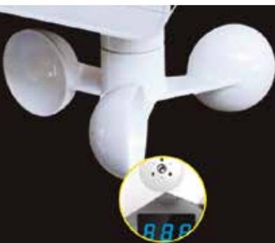
El eje rotatorio en el sensor de viento reduce la fricción y aumenta la sensibilidad
